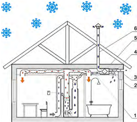
Рис. 7.18. Устройство и функционирование ВКС в режиме отопления:
