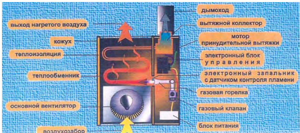
Рис 7.5. Устройство воздухонагревателя США
